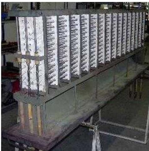
Les éléments de chauffe sont composés de rubans métalliques à base de molybdène, tantale et tungstène maintenus par des isolants en céramique haute température.
